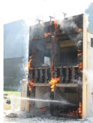
Vue de la façade à t = 30 min, extinction du foyer
