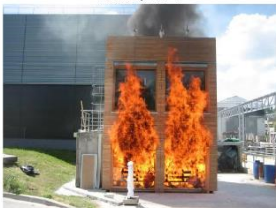
Vue de la façade à t = 37 sec
